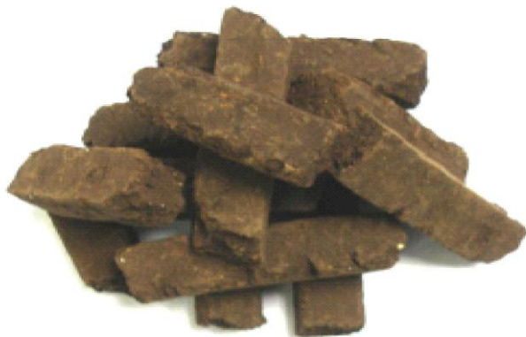
Рис. 1. Образец брикетов из отходов животноводства
